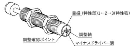
**Cタイプ**(目盛1~7、調整軸 基準点:2)
