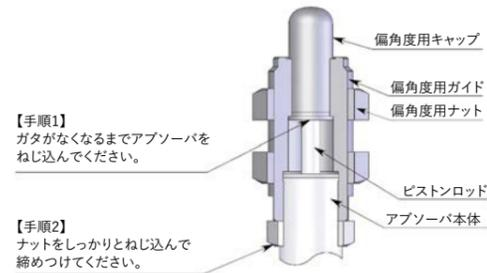
偏角度用ガイドに偏角度用キャップを挿入し、アブソーバ本体をねじ込んでいきます。その後、偏角度用キャップとピストンロッドのガタがなくなるまでねじ込み、その位置でナットをしっかりと締め込んでください。
