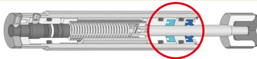
通常のアブソーバの場合、付着した粉塵がストロークする際に内部へと侵入してしまいます。それによってシールを傷め、オイル漏れ等の不具合へつながります。
