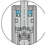
ダストシール仕様の場合、ダストリップ付Uパッキンを使用している為、付着した粉塵が内部に侵入しない構造になっています。
