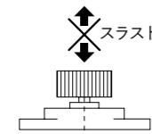
★相手アーム(ギア)とダンパーのギアの平行度はできるかぎり正確に取り付けてください。
