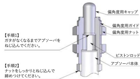
偏角度用ガイドに偏角度用キャップを挿入し、アブソーバ本体をねじ込んでいきます。その後、偏角度用キャップとピストンロッドのガタがなくなるまでねじ込み、その位置でナットをしっかりと締め込んでください。
