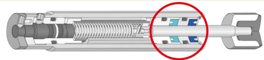
通常のアブソーバの場合、付着した液体がストロークする際に内部へと浸入してしまいます。本来であれば内部のアクムレータが圧縮されることで、押し込まれたピストンロッド分の体積を吸収する仕組みになっていますが、外部から液体が浸入してしまうことによって、アクムレータが常に圧縮された状態になってしまいます。すると、ピストンロッドの体積吸収が行えず、ピストンロッドが押し込めなくなってしまうといった不具合に繋がります。
