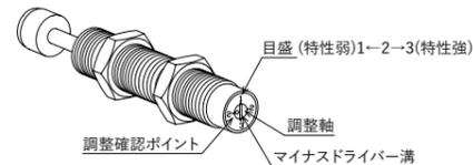
**Cタイプ**(目盛1~7、調整軸 基準点:2)
