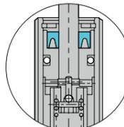
耐クーラント仕様の場合、内部Uパッキンを二重にしている為、付着した液体が内部に浸入しない構造になっています。
