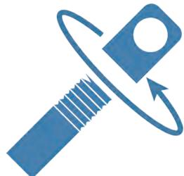
豊富な取付金具はすべてねじ込み式。工具不要で簡単に取り外しが可能ですので、取替も容易です。メンテナンス交換時にも、金具だけ使いまわしていただければ、メンテナンス費用を抑えられます。
