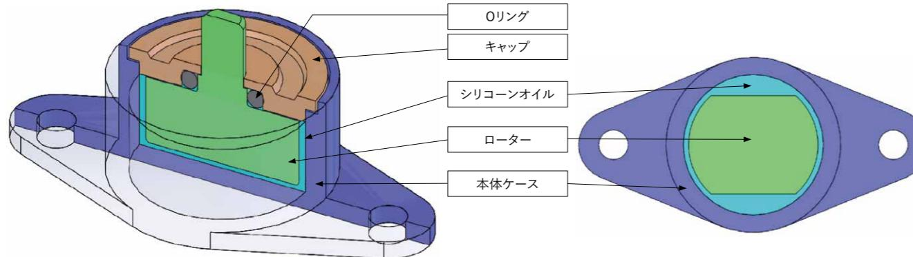
オイルの粘性抵抗により発生する制動力(ブレーキ力)を利用した回転系のダンパーです。
