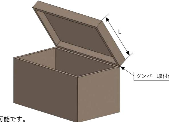
上記の計算式にて蓋が閉まる直前に発生する最大トルクを求め、試作品にて実機での動作確認をした上で、実際に必要なトルクを決定します。
