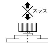
★相手アーム(ギア)とダンパーのギアの平行度はできるかぎり正確に取り付けてください。
