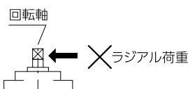
●回転軸(ギア)にラジアル方向の荷重をかけると、オイル漏れ、トルク不良、軸破損(ギア付きの場合、ギア破損)等の可能性があります。
