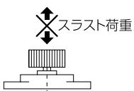
★組立に際しての相手アーム(ギア)とダンパーのギアの平行度はできるかぎり正確に取り付けてください。
