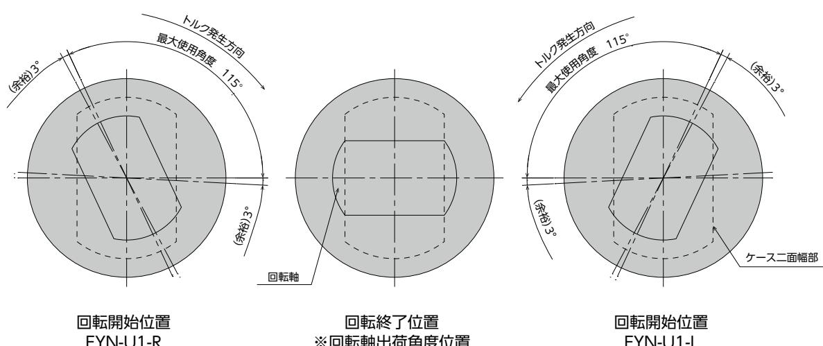
⑥ダンパーは回転軸を上から見て時計回り、反時計回りそれぞれにトルクが発生するタイプがあります。使用方法に応じて機種をお選びください。
