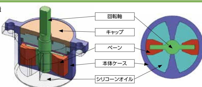
オイルの圧力を利用した回転系ダンパーです。上図のような構造にて、オイルの粘性、ベーンと本体ケースのクリアランス及びベーンの受圧面積により発生するトルクは変化します。また、機種によって最大使用角度が異なります。
