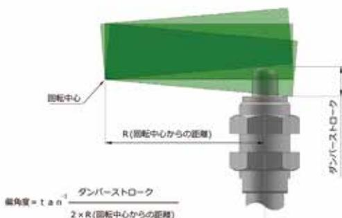
ストロークエンドで衝突物がアブソーバに対し垂直に停止しないが、最も偏角度が小さくなる取り付け。
