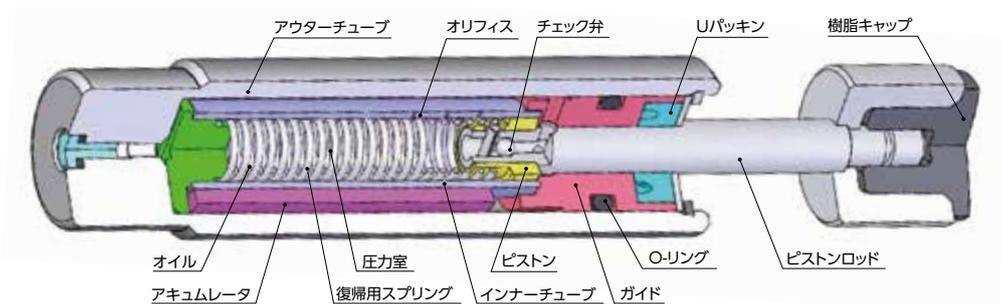
調整機構がないので、全長寸法は調整式より短くなります。オリフィス設計を特注対応することにより、最適な吸収特性を得ることが可能です。また、特性のばらつきが少ないため2本以上の並列使用も可能です。
