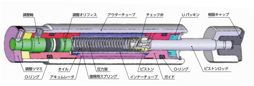
本体後部の調整つまみ(調整軸)を回転させ、圧力室から流出するオイルの流量を調整することにより吸収特性を調整します。多孔式の場合は、最終オリフィスのみの調整となり、調整範囲は大きくありません。単孔式の場合は、調整範囲が広くなります。オリフィス面積はアナログ的に変化しますので吸収特性の微調整が可能です。
