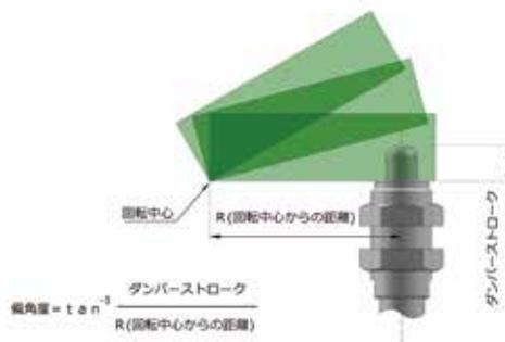
アブソーバの配置が容易で、偏角度が比較的小さい取り付け。
