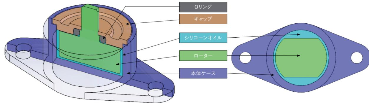
オイルの粘性抵抗により発生する制動力(ブレーキ力)を利用した回転系のダンパーです。構造は上図のようになっており、オイルの粘性、ローターと本体ケースのクリアランス、オイルの接触面積等により発生する制動トルクは変化します。使用角度の制限はありません。
